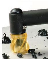
Entwickelt, um schmutzige chemische Lösungsmittel und langsames und ineffizientes Kratzen von Hand zu ersetzen. Die scharfen, harzgebundenen Klingen des SR Cutters entfernen schnell die meist dicken Beschichtungen aus Polysulfid- und Polythioether-Material, die auf den Nähten von Tragflächen und Kraftstofftanks angebracht sind, ohne den Untergrund zu beschädigen.
