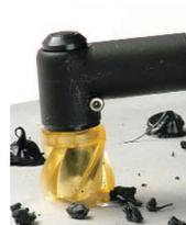
汚れる原因となる化学溶剤や遅くて非効率的な手でのこすり洗いに置き換わります。SRカッターの鋭いレジジン結合ブレードにより、主翼パネルと燃料タンクの継ぎ目に塗布されたポリサルファイドとポリチオエーテル材料の通常厚いコーティングを下地に損傷を与えることなく素早く除去することができます。
