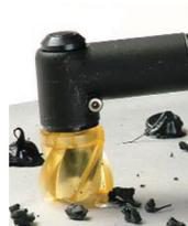
Diseñado para sustituir los sucios disolventes químicos y el lento e ineficiente raspado manual. Las afiladas cuchillas de resina de las Cortadoras SR eliminan rápidamente los revestimientos normalmente gruesos de material de polisulfuro y poliéster aplicados a las costuras de los paneles de las alas y los depósitos de combustible sin dañar el sustrato.
